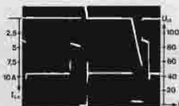
Bild 13 PNP-POWER-Transistor oben: Kollektorstrom I_c = 2.5 \text{ A} unten: Kollektor-Emitterspannung U_{CE} = 20 \text{ V} t = 2 \text{ ms/cm}
